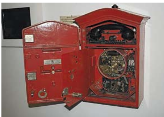
Рис. 1. Ручной извещатель с телеграфной передачей сигнала. Британская империя, XIX в.
